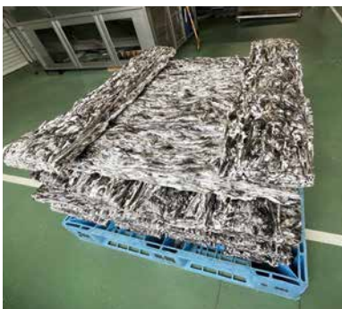
加熱して容積を減らしポリスチレン原料(ポリスチレン・インゴット)化された発泡スチロール
